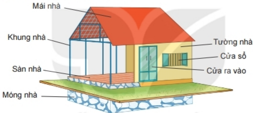
Hình 1.2. Cấu tạo chung của nhà ở
